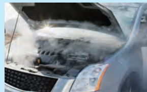
冷却不良によるオーバーヒート
